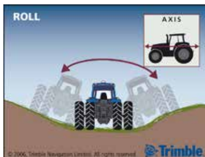
Rollen: Bewegung um die Längsachse
