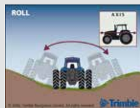
Rollen: Bewegung um die Längsachse
