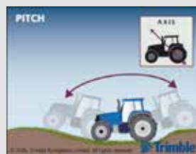
Nicken: Bewegung um die Querachse
